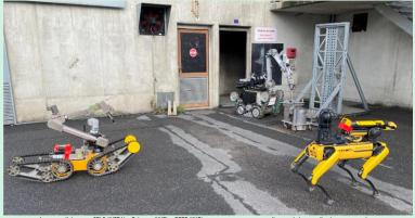
Activité collaborative EOLE (INTRA) - Telemax (KHG) - SPOT (KHG) pour reconnaissance visuelle et radiologique d'un bâtiment accidenté et potentiellement irradiant (présence de sources) et contaminé
